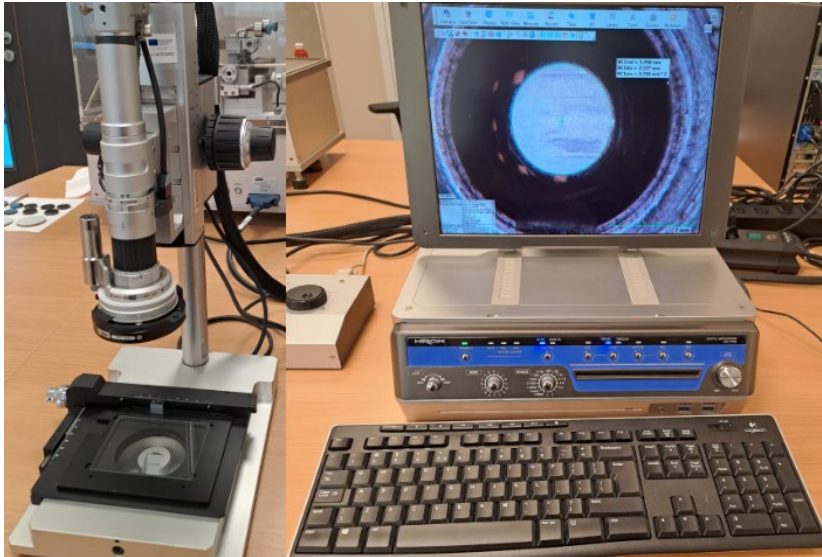
4.8. att. Digitālais mikroskops Hirox lodītes noslīpētās plaknes laukuma noteikšanai pirms un pēc eksperimenta.
