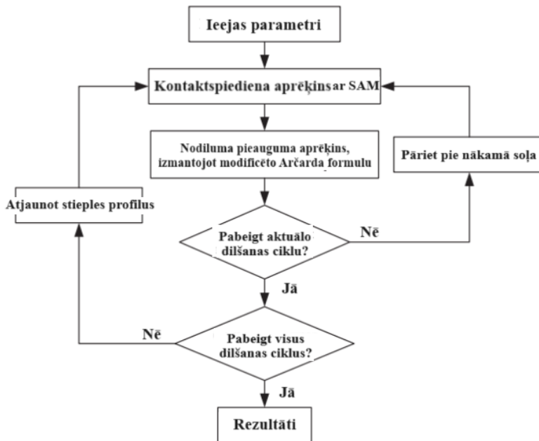
1.9. att. Tērauda stieplu nodiluma noteikšanas algoritms [28].
