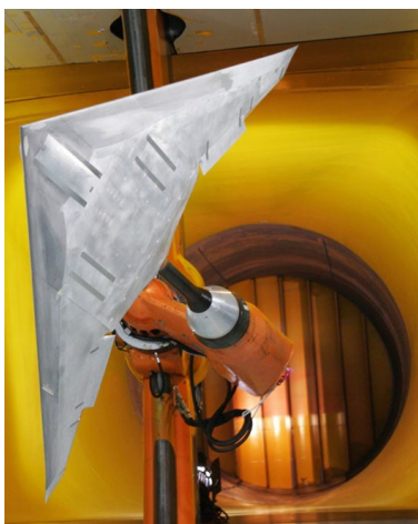
8.5.att. Delta spārna modelis, kas uzstādīts uz aizmugurēju stieni, kompānijas ONERA F1 vēja tunelī [61].
