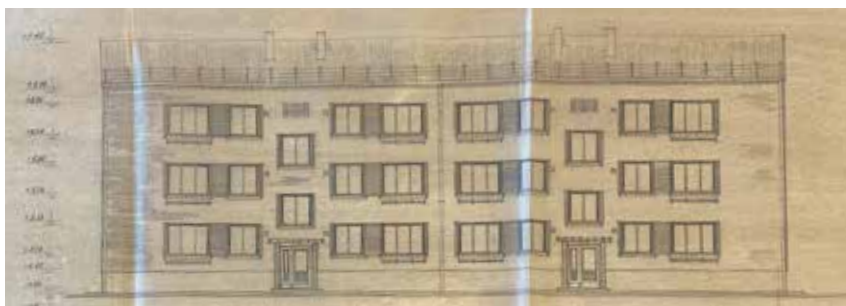
48. attēls. Tipveida projekta 1-316-9. sērijas dzīvojamās ēkas fasāde no baltiem silikāta ķieģeļiem un starpailām no sarkaniem ķieģeļiem (1960).
