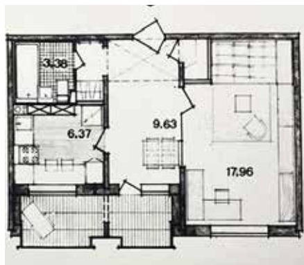
103. attēls. Tipveida projekta 119. sērijas deviņstāvu dzīvojamās ēkas vienistabas dzīvokļa plānojums (39,50 m 2 ; 20. gadsimta 70. gadi).
