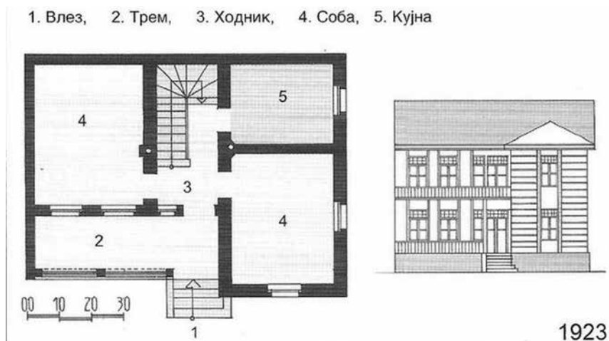
7. attēls. Jovan Tašković savrupmājas pirmā stāva plāna un mājas ielas fasādes skata reprodukcija Hajduk Veljko ielā ( Egejska ) Skopjē (1923). 1 – ieeja, 2 – veranda, 3 – gaitenis, 4 – istabas, 5 – virtuve.
