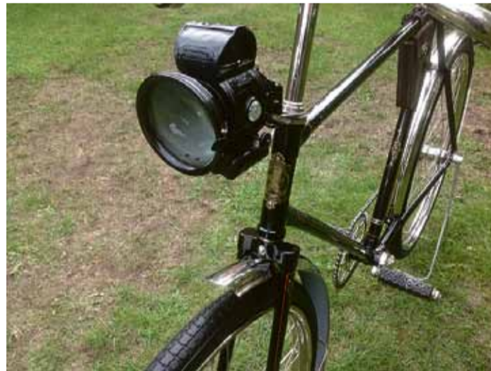
Karbīda lampa, kas uzmontēta uz Kurzemē atrasta velosipēda, kurš 1935. gadā būvēts J. Mucenieka darbnīcā.
