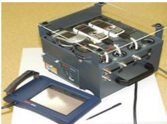
2.8 att. QVoice kompleksa mērīšanas un komutācijas bloks kopā ar vadības paneli.
