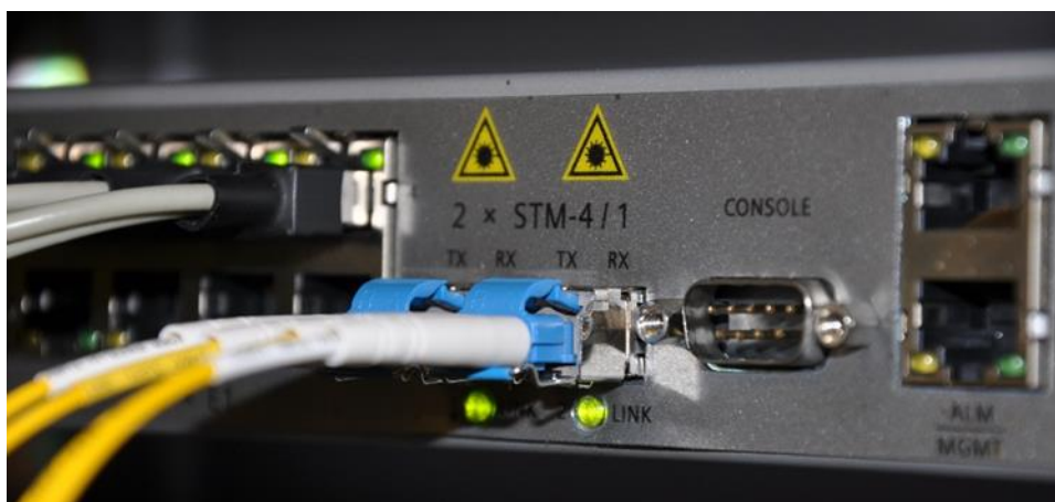
6.2. att. Optiskais multipleksors ar instalētiem SFP moduļiem
