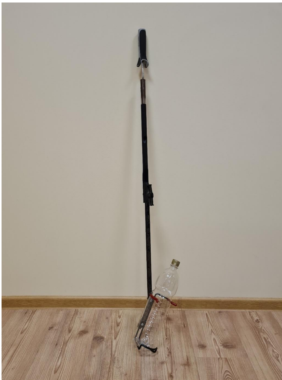
1.attēls. ūdens paraugu ņemšanas iekārta ar iestiprinātu pudeli ūdens paraugu ņemšanai
