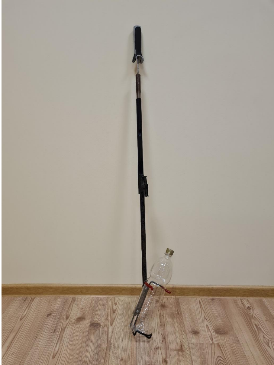
1.attēls. ūdens paraugu ņemšanas iekārta ar iestiprinātu pudeli ūdens paraugu ņemšana
