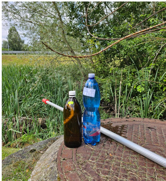
2.attēls. Paraugu ņemšana no pēdējās skatākas lietus notekūdens attīrīšanas iekārtas sistēmā pirms izplūdes dīķī (01.08.2024.)
