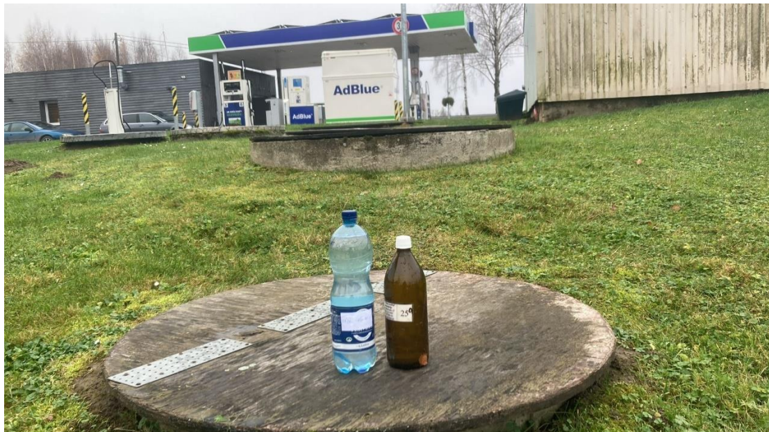
2. attēls. Skats uz aku notekūdeņu attīrīšanas iekārtu izplūdē, kurā tika ņemts lietus notekūdeņu paraugs (12.11.2024.)
