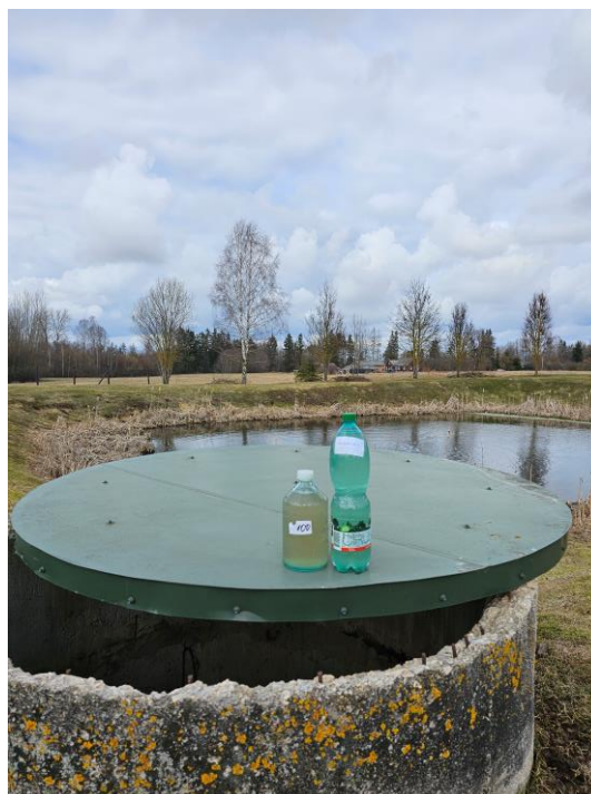
2.attēls. Skats uz parauga ņemšanu no pēdējās kanalizācijas skatakas notekūdeņu attīrīšanas iekārtā pirms izplūdes dīķī (25.03.2024.)
