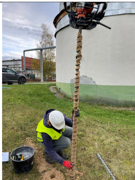
6.Foto. Grunts parauga noņemšana no zondēšanas urbuma Nr.1.
