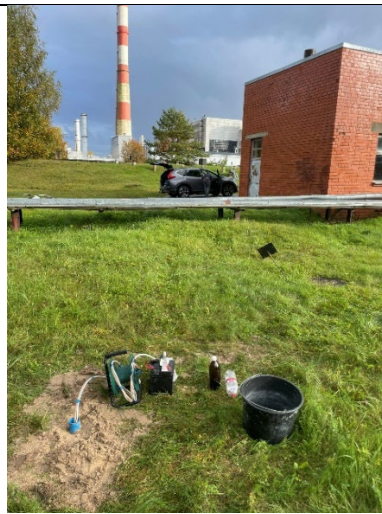
10.Foto. Gruntsūdens parauga noņemšana no pagaidu novērošanas akas Nr.3 pie mazuta nosēduma sūkņu stacijas
