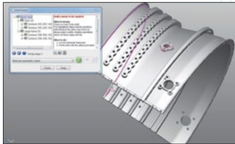
Модуль Solid Doctor выявляет все ошибки в импортированной CAD-модели и классифицирует их по типу
