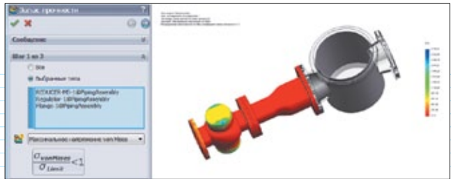
Рис. 14. Коэффициент запаса прочности для выбранных тел
