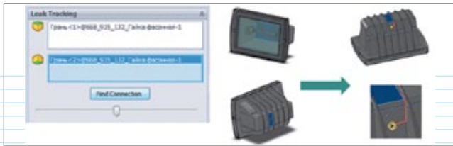
Рис. 5. Окно инструмента Leak Tracking и результат поиска “протечки”
