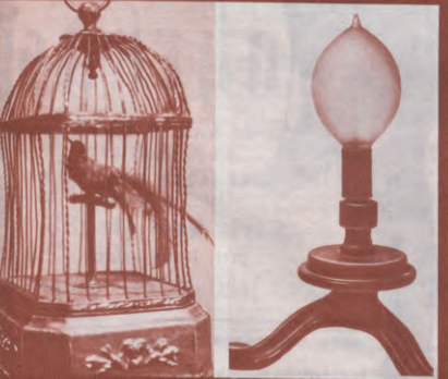
Mehāniskais pulstenis (18. gadsimta beigās). Tas darbojas pēc pulkšstena mehānisma principa. Darba programma ierakstīta zobratos, kuri notiekāši rēķinā ar sviru sistēmas palīdzību koordinē skaņu sistēmas darbību ar pušņa kustībām.
